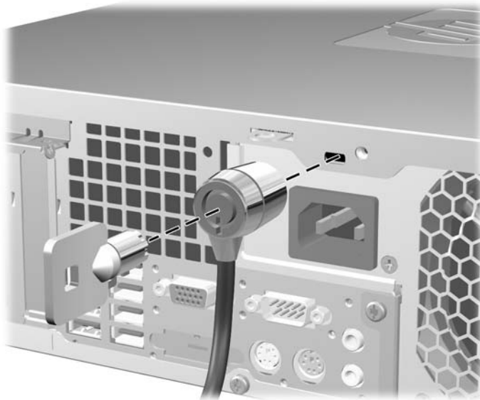
Figure C-1 Installation d'un câble de sécurité
