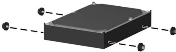
Εικόνα 2-39 Τοποθέτηση βιδών-οδηγών μονάδας σκληρού δίσκου
