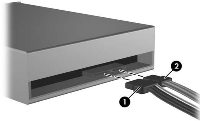
△ **ACHTUNG:** Ein SATA-Datenkabel darf nie enger als 30 mm im Radius gebogen werden. Eine engere Schlaufe kann zum Bruch der inneren Kabel führen.
