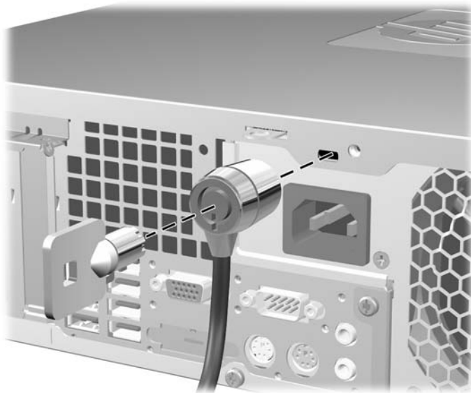
Slika C-1 Ugradnja sigurnosnog kabela
