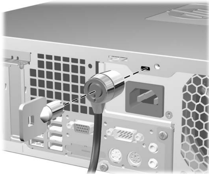
Gambar C-1 Memasang Kunci Kabel
