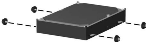
12. Allineare le viti guida agli slot dell'alloggiamento dell'unità, spingere l'unità nell'alloggiamento, quindi reinserirla fino a bloccarla in sede.
