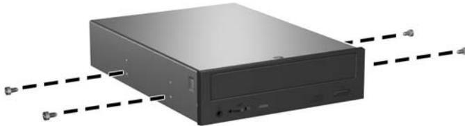
9. Posizionare le viti guida dell'unità negli slot J nell'alloggiamento unità. Quindi, far scorrere l'unità in direzione della parte anteriore del computer fino a quando non scatta in posizione.
