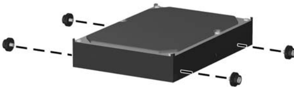
図 2-39 ハードディスク ドライブのガイド用ネジの取り付け
