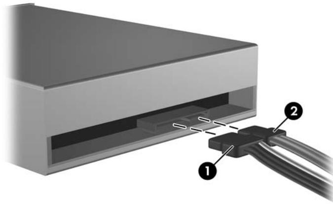
△ **PRECAUCIÓN:** Nunca doble o curve un cable de datos SATA más que un radio de 30 mm (1,18 pulgadas). Un redoble muy pronunciado puede quebrar los alambres internos.
