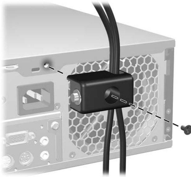
Afbeelding C-5 Slot aan het chassis bevestigen
