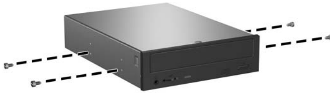
Rysunek 2-26 Instalowanie wkrętów prowadzących w napędzie optycznym
