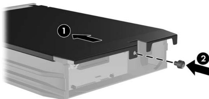
10. Faça deslizar a portadora da unidade de disco rígido para dentro da caixa no computador e bloqueie-a com a chave fornecida.
