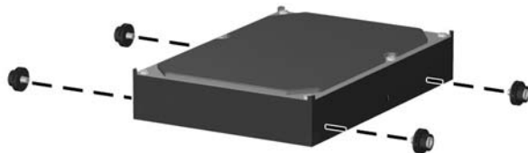
Figura 2-39 Instalar parafusos-guia da unidade de disco rígido
