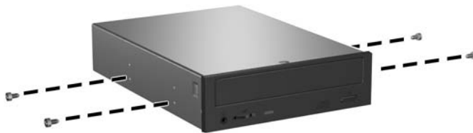
Obrázok 2-26 Inštalácia vodiacich skrutiek do optickej jednotky
