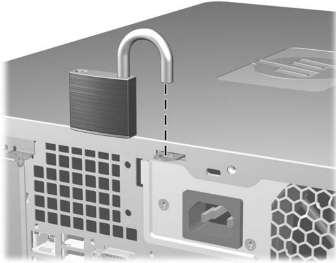
Obrázok C-2 Inštalácia visacieho zámku
