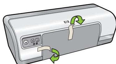
**2** Откройте верхнюю крышку. Извлеките оранжевый транспортировочный фиксатор.
