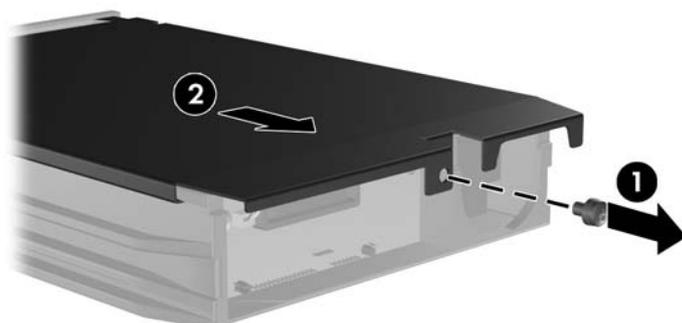
3. Retire la banda adhesiva que sujeta el sensor térmico a la parte superior de la unidad de disco duro (1) y extraiga el sensor térmico del soporte (2).
