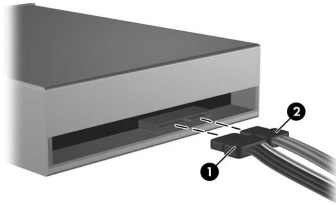
△ **PRECAUCIÓN:** Nunca pliegue o enrolle un cable de datos SATA de manera que el radio sea inferior a 30 mm (1,18 pulgadas). Un plegado excesivo puede romper los cables internos.
