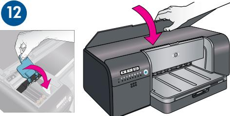
Schließen Sie die blaue Abdeckung und schließen Sie anschließend die obere Klappe.
