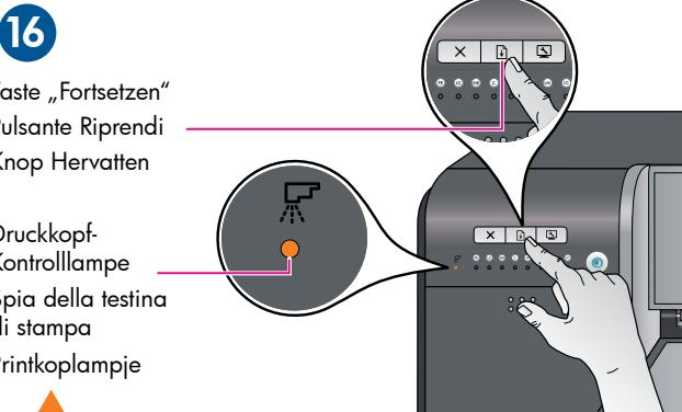
**Drücken Sie auf „Fortsetzen“ [1], um die Kalibrierung des Druckers zu starten.** Die Kalibrierung dauert 30-40 Minuten. Installieren Sie in der Zwischenzeit die Software (Schritt 17). Wenn die Druckkopf-Kontrolllampe [F] ausgeht, ist die Kalibrierung abgeschlossen.
