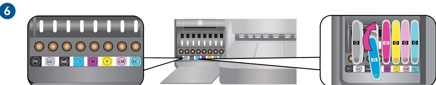
Setzen Sie alle acht Tintenpatronen in die farbkodierten Steckplätze ein. Drücken Sie jede Patrone fest, bis sie einrastet.
