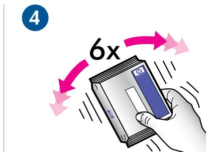
Schütteln Sie jede Tintenpatrone gut durch (6 mal), bevor Sie sie auspacken.
