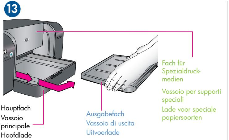
Entfernen Sie das **Ausgabefach**, indem Sie es fest herausziehen. Das Ausgabefach ist der bewegliche Teil oberhalb des Hauptfachs. **Hinweis:** Vergewissern Sie sich, dass das Fach für **Spezialdruck-medien** geschlossen ist.
