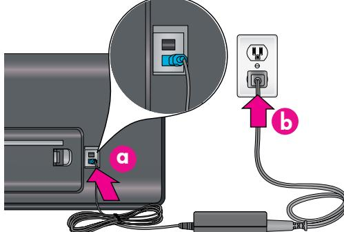
**Utenti Windows: non collegare il cavo USB fino a quando non viene richiesto dal programma di installazione (passaggio 17).** Collegare il cavo di alimentazione alla stampante (a) e successivamente ad una presa elettrica (b). La stampante si accende automaticamente.
