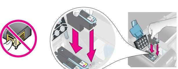
Entnehmen Sie die Druckköpfe der Verpackung und entfernen und entsorgen Sie die orangefarbenen Abdeckungen (a). Berühren Sie nicht die goldfarbenen Kontakte. Setzen Sie die Druckköpfe in die farbkodierten Steckplätze und drücken Sie sie fest, bis sie einrasten (b).
