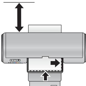
**Important :** En cas d'impression sur un papier toilé ou un support légèrement courbé, ouvrez le capot supérieur afin de vérifier que le support est chargé en douceur entre les rouleaux d'entraînement. Veillez à refermer le capot principal.
