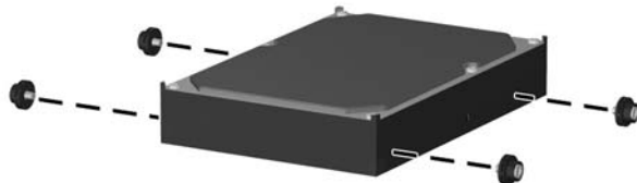
Slika 2-28 Ugradnja vodećih zavrtnja u čvrsti disk
