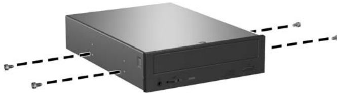
Slika 2-26 Ugradnja vodećih zavrtnja u optički uređaj
