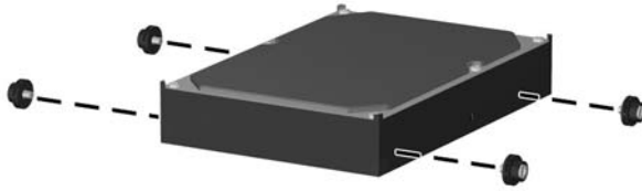
Şekil 2-39 Sabit Sürücü Kılavuz Vidaları Takma
