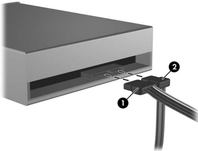
圖示 2-29 連接電源線和資料排線
