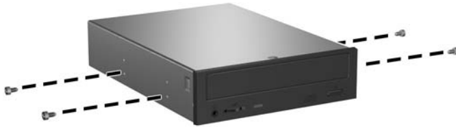
圖示 2-26 將導引螺絲鎖入光碟機
