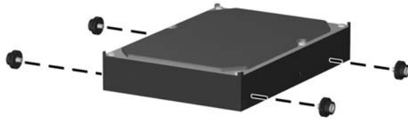
圖示 2-39 安裝硬碟機導引螺絲
