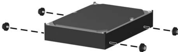
Kuva 2-39 Kiintolevyn ohjainruuvien asentaminen
