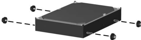
Abbildung 2-28 Anbringen der Festplattenführungsschrauben
