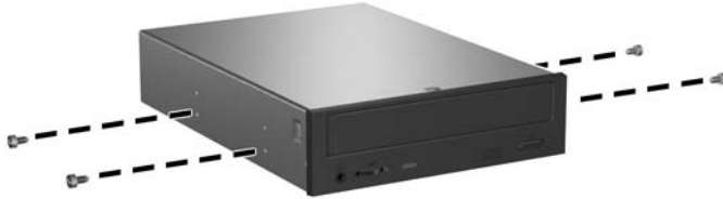
Abbildung 2-21 Installieren von Führungsschrauben (am optischen Laufwerk)
