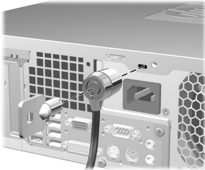
Figura C-1 Instalación de un bloqueo de cable
