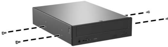
Figura 2-26 Instalación de tornillos guía en la unidad óptica
