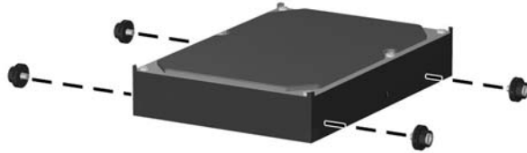
Figura 2-39 Instalación de los Tornillos Guía en la Unidad de Disco Duro
