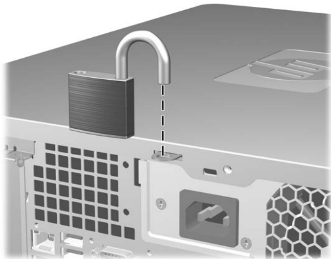
Figura C-2 Instalación de un candado
