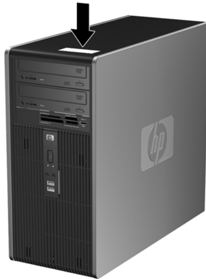
Figur 1-3 Plassering av serienummer og produkt-ID
