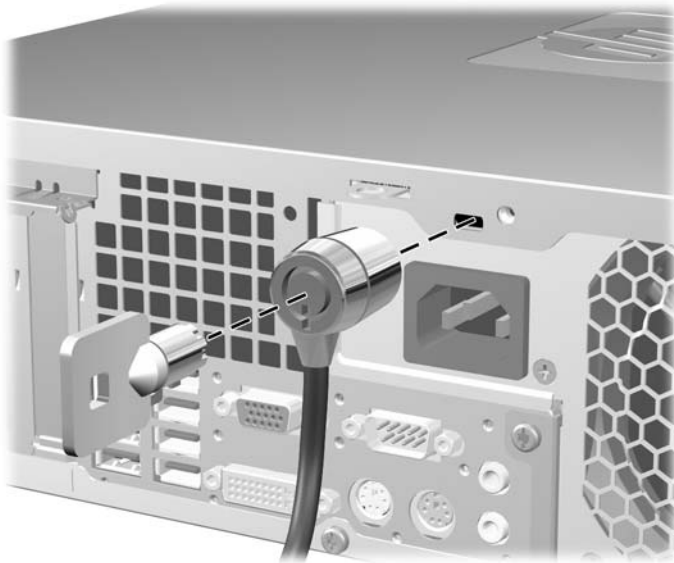
Figur C-1 Installere en vaierlås
