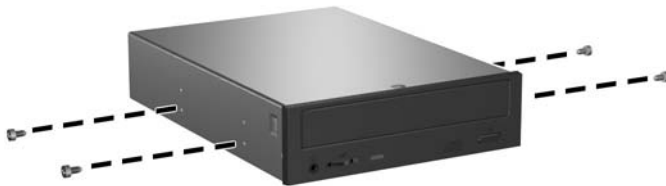
Figur 2-26 Installere styreskruer i den optiske stasjonen
