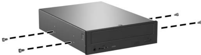
Slika 2-26 Pritrditev vodilnih vijakov na optični pogon
