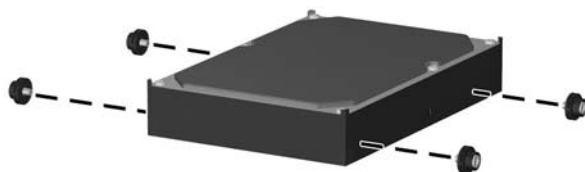
Slika 2-39 Pritrjevanje vodilnih vijakov za trdi disk
