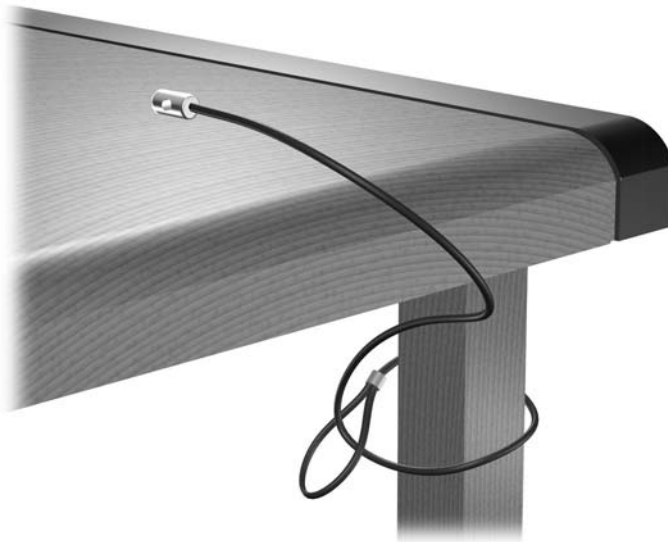
Slika C-3 Pritrditev kabla na nepremični predmet
