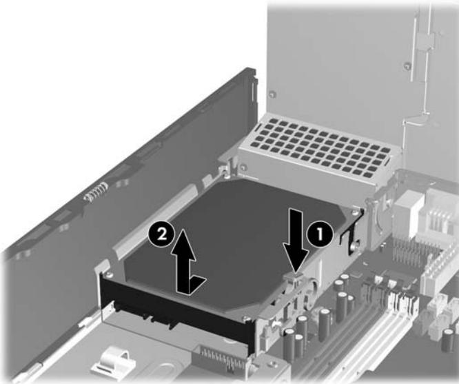
11. Para instalar una unidad de disco duro, deberá retirar los tornillos de guía aislantes de la vibración de color gris plata y azul de la unidad de disco duro antigua e instalarlos en la unidad nueva.
