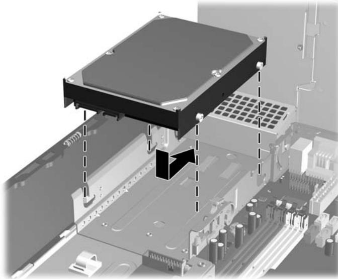
13. Conecte los cables de alimentación y de datos a la parte posterior de la unidad de disco duro.
