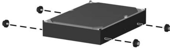
12. Alinee los tornillos de guía con las ranuras del alojamiento de la unidad, presione la unidad de disco duro en el alojamiento y, a continuación, deslice la unidad hacia atrás hasta que quede bloqueada en su posición.
