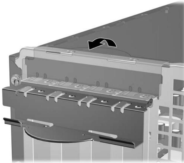
9. Antes de instalar la tarjeta de expansión, extraiga la cubierta de ranura de expansión o la tarjeta de expansión existente.
