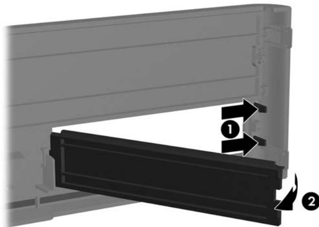
3. Para retirar la tapa del panel de 5,25 pulgadas, presione las dos lengüetas de retención que sujetan la tapa del panel hacia el borde exterior izquierdo del panel (1) y tire de la tapa del panel hacia adentro para retirarla (2).
