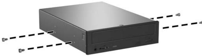
9. Coloque los tornillos de guía de la unidad en las ranuras en J del compartimiento de la unidad. A continuación, deslice la unidad hacia la parte delantera del ordenador hasta que quede bloqueada en su posición.
