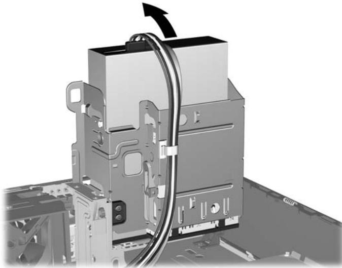
8. Desconecte el cable de alimentación (1) y el cable de datos (2) de la parte posterior de la unidad óptica.
