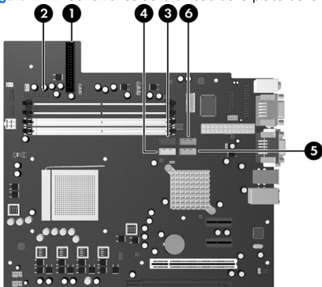
**Tabla 2-3** Conexiones de la unidad de la placa del sistema
