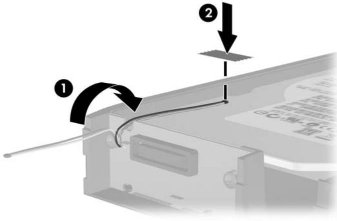
9. Deslice la cubierta sobre el soporte (1) y sustituya el tornillo en la parte trasera del soporte para asegurar la cubierta (2).
