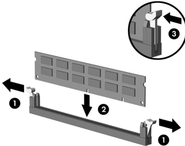
**NOTA:** Los módulos de memoria sólo se pueden instalar de una forma. Haga coincidir la muesca del módulo con la pestaña del zócalo de memoria.
