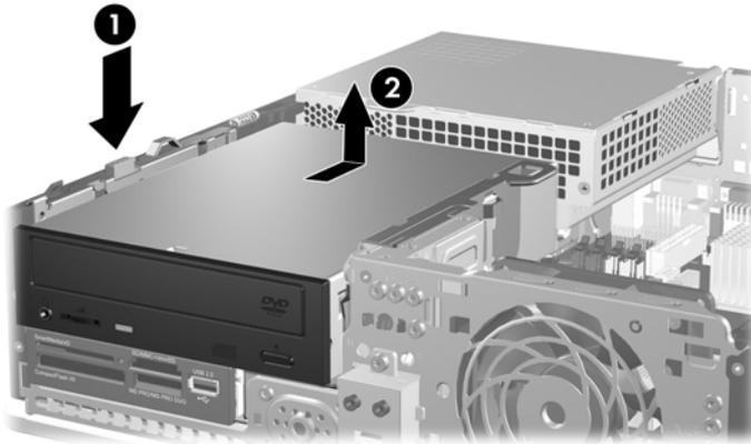
**NOTA:** Para volver a colocar la unidad óptica, realice el procedimiento de extracción en orden inverso. Cuando vuelva a colocar la unidad, transfiera los cuatro tornillos de guía de la unidad antigua a la nueva.
