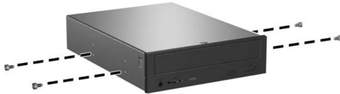
ภาพ 2-26 การติดตั้งสกรูตัวนำในไดรฟ์ถอดออก
