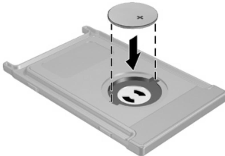
3. 將電池置放處外蓋的卡榫裝入電池置放處的插槽，然後以順時針方向將它關閉。
