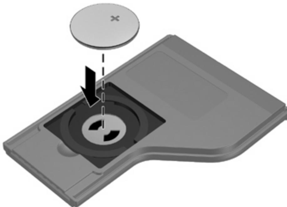
3. 將電池置放處外蓋 (1) 對齊電池置放處，然後向下壓以關閉外蓋 (2)。
