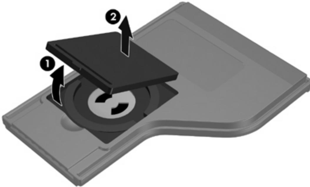
2. Setzen Sie die Batterie mit ihrem Plus-Pol nach oben in das Batteriefach ein.
