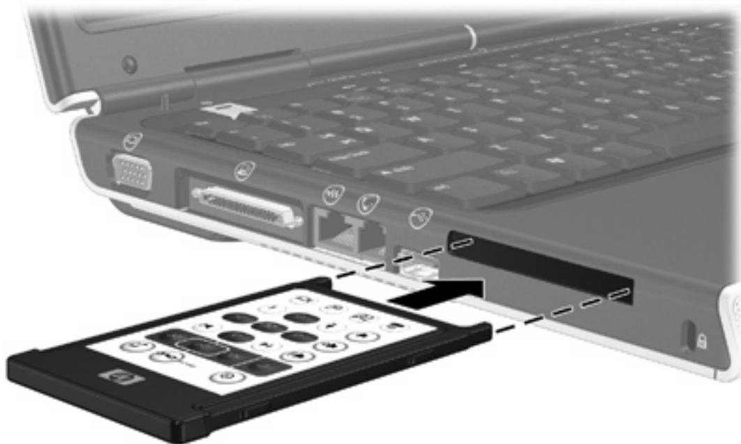
So entfernen Sie die Fernbedienung aus dem PC Card-Steckplatz:
