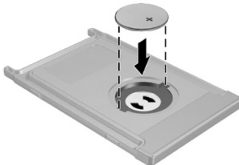
3. Setzen Sie die Führungsnasen an der Batteriefachabdeckung in die Schlitz im Batteriefach ein, und drehen Sie die Abdeckung im Uhrzeigersinn, um sie zu schließen.
