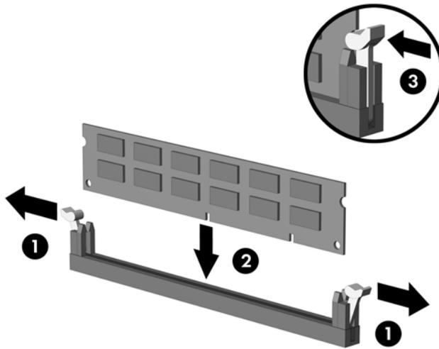
**REMARQUE :** Un module mémoire ne peut être installé que dans un sens. Faites coïncider l'encoche du module avec le détrompeur du support de mémoire.
