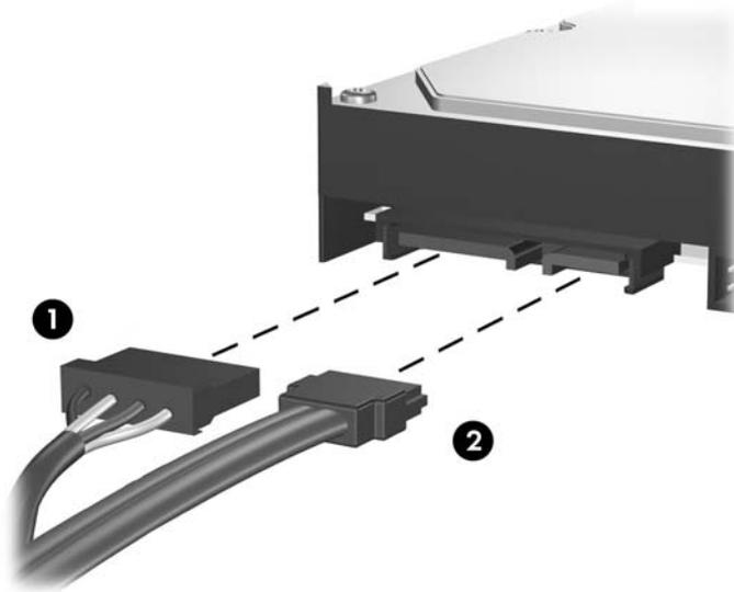
△ **ATTENTION :** Ne froissez ou pliez jamais un câble de données SATA suivant un rayon supérieur à 30 mm. Un angle aigu peut briser les fils internes.
