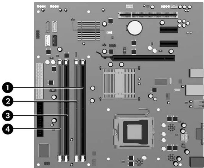
**Tableau 2-1** Emplacement des supports DIMM
