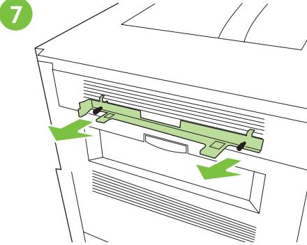
Ξεβιδώστε το βραχίονα κλειδώματος από τον εκτυπωτή. **Σημείωση:** Μην ξεχάσετε το βραχίονα κλειδώματος κατά την επανατοποθέτηση ή τη μετακίνηση του πολυλεπούργικου μηχανήματος τελικής επεξεργασίας. Ο βραχίονας κλειδώματος είναι απαραίτητος για την εγκατάσταση.
