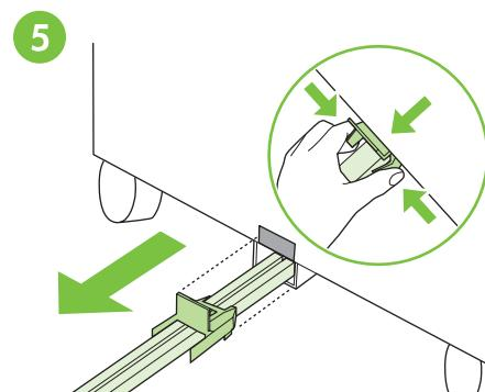
要松开蓝色塑料托架，请按住松开簧片并将连接杆从金属槽滑入纸盘 4 或支架。
