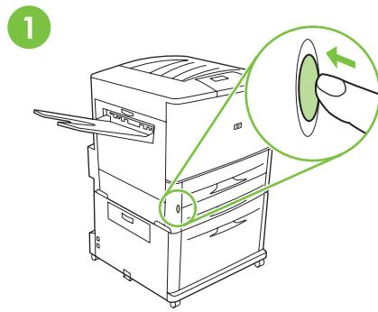
Jeśli drukarka jest podłączona do gniazda zasilania, naciśnij przycisk zasilania, aby ją wyłączyć (przycisk niewciśnięty).
