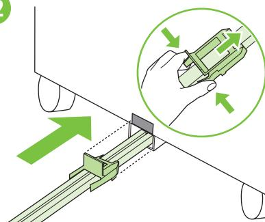
将蓝色塑料托架滑入金属槽，直至其锁定到位。**注：**托架板将盖住纸盘 4 或支架上的灰色校准标签。
