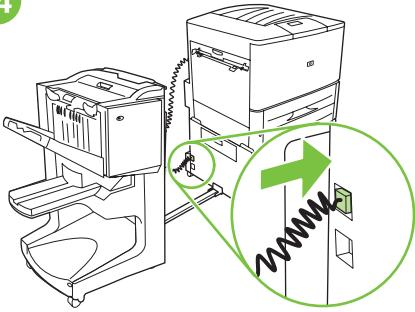
将设备的电源线连接至纸盘 4 或支架的上部接口。
