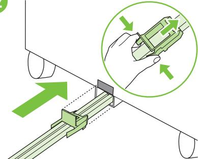
Wsun niebieski plastikowy wspornik do metalowego gniazda tak, by zablokować go we właściwym położeniu.
