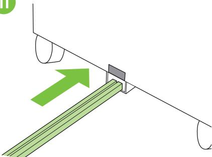
Umieść końcówkę pręta w metalowym otworze w kształcie litery U w podajniku 4 i ustal właściwe położenie pręta względem szarego oznaczenia.
