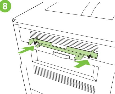
Placera låsskyddet framför skrivarens övre luckhål och anslut spärren genom att sätta i skruvarna.
