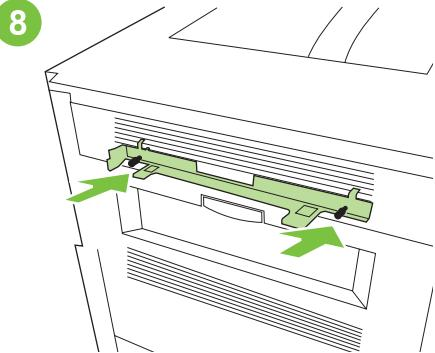
Τοποθετήστε το βραχίονα κλειδώματος μπροστά στις οπές καλυμμάτων του εκτυπωτή και συνδέστε το βραχίονα επανατοποθετώντας τις βίδες.
