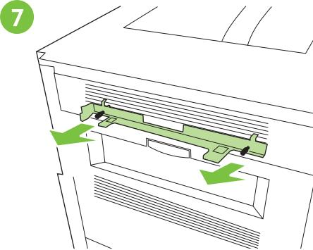
从打印机上拧下闭锁托架的螺丝。
