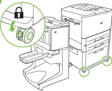
将打印机放置在安装位置，然后锁定前脚轮。**注意：**设备脚轮不能旋转。移动时请小心，以免将连接杆弄断。
