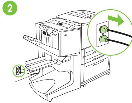
断开打印机电源线与交流电源插座之间的连接。断开纸盘 4 或支架的电源线与交流电源插座之间的连接。
