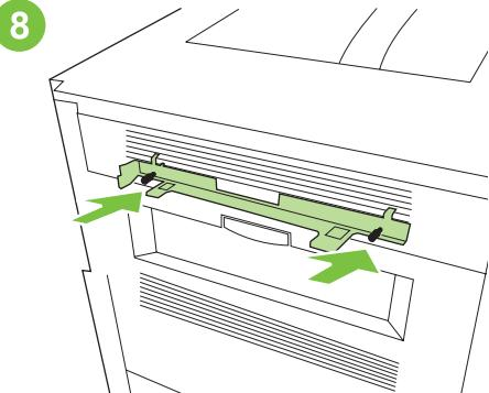
将闭锁托架放在打印机护盖孔的前面，重新插入螺丝，固定连接的托架。
