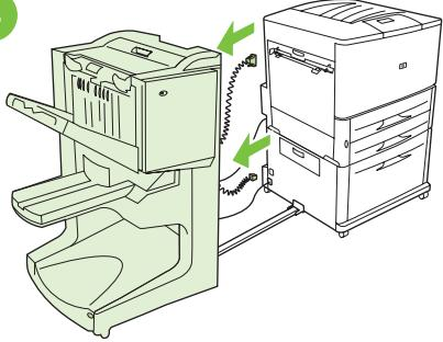
Koppla bort enhetens nätsladdar från fack 4 eller hållaren, och koppla bort kommunikationskabeln från skrivaren.
