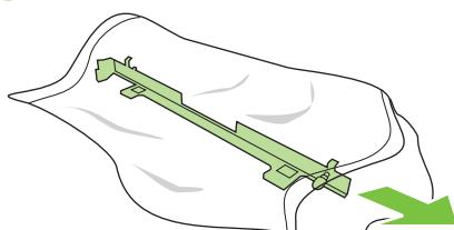
拆除闭锁托架上的塑料袋。
