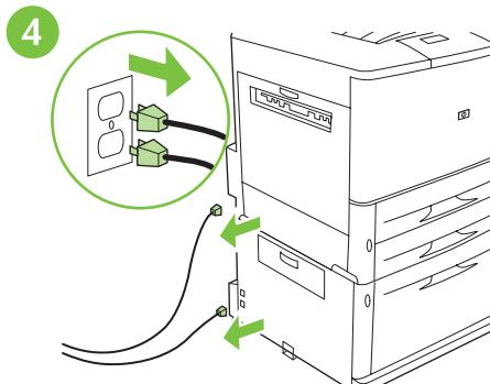
Wyjmij z gniazd po obu stronach wtyczki przewodów zasilających drukarki i podajnika 4.
