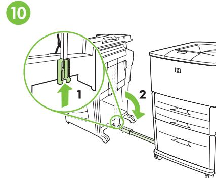
Przesuń niebieski wspornik w górę, aby odblokować pręt łączący. Opuść pręt łączący tak, aby znajdował się w pozycji horyzontalnej.
