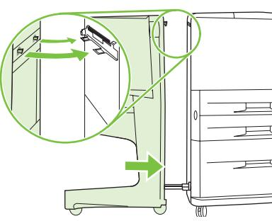
将设备推向打印机，设备上的两个塑料挂钩应锁定在闭锁托架上。**注意：**将设备连接至打印机之前，请清除设备周围的所有障碍物。
