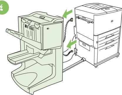
قم بفصل سلك التيار الخاص بالجهاز من الدرج ٤ أو الحامل ثم قم بفصل كبل التوصيل من الطابعة.
