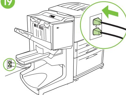
将打印机电源线重新连接至交流电源插座。将纸盘 4 或支架的电源线重新连接至交流电源插座。
