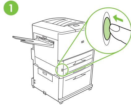
如果您已经将打印机连接至交流电源插座，请按下电源按钮关闭电源（按钮凸出）。
