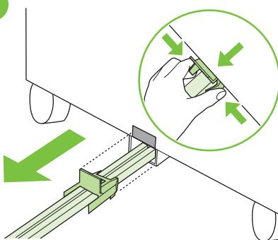
Aby zwolnić niebieski plastikowy wspornik, ściśniej klapki zwalniające i wysuń preł łączący z metalowego gniazda w podajniku 4 lub stojaku.
