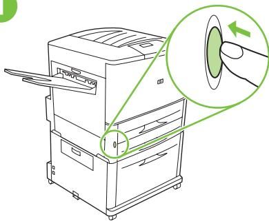
**Aby przeprowadzić dezinstalację finisera wielofunkcyjnego:** Wyłącz drukarkę, naciskając przycisk zasilania (przycisk niewciśnięty).
