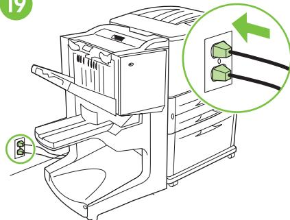
Podłącz przewód zasilający drukarki do gniazda zasilania. Następnie podłącz przewód zasilający podajnika 4 lub stojaka do gniazda zasilania.
