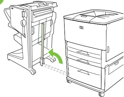
Pociągnij niebieską dźwignię w dolnej części pręta i podnieś pręt.
