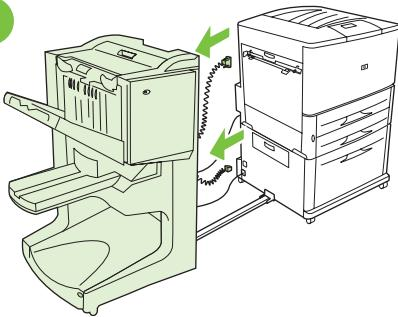
Odlacz przewód zasilający urządzenia od podajnika 4 lub stojaka oraz przewód łączący do drukarki.
