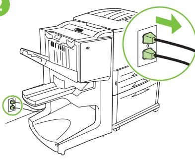
Odłącz przewód zasilający drukarki od gniazda zasilania. Następnie odłącz przewód zasilający podajnika 4 lub stojaka od gniazda zasilania.
