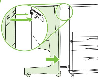
Dosuń urządzenie do drukarki. Dwa plastikowe zaczepy umieszczone na urządzeniu powinny znaleźć się w otworach listwy montażowej.
