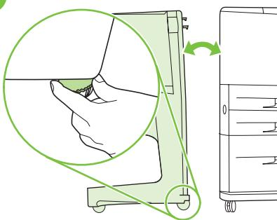
Εάν υπάρχει ένα κενό μεταξύ του εκτυπωτή και της συσκευής, στο πάνω ή στο κάτω μέρος, ρυθμίστε τα μπλε αλφάδια πάνω από τους τροχούς της συσκευής μέχρι το κενό να εξαφανιστεί.
