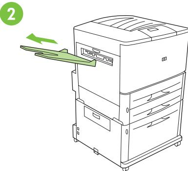
卸下面朝上的纸槽（如已安装），并将其保存好。将多功能装订器连接至打印机后，便不需要使用该纸槽了。
