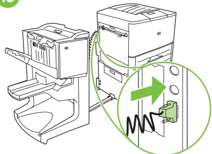
Podłącz przewód łączący do złącza drukarki oznaczonego jako „Accessory” (Wyposażenie).
