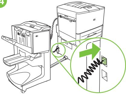
Podłącz przewód zasilający urządzenia do górnego gniazda podajnika 4 lub stojaka.
