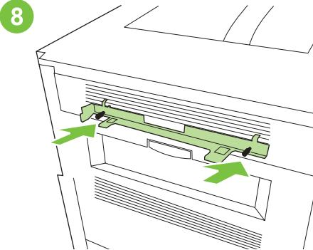
Umieśc listwę montażową na wprost otworów i zamocuj ją za pomocą śrub.
