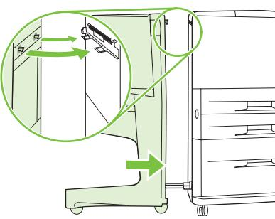
Skjut enheten mot skrivaren. De två plastkrokarna på enheten måste läsas fast på låsspärren.
