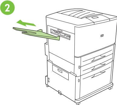
Ta bort utmatningsfacket för framsidan uppåt (om det installerats) och lägg det åt sidan.
