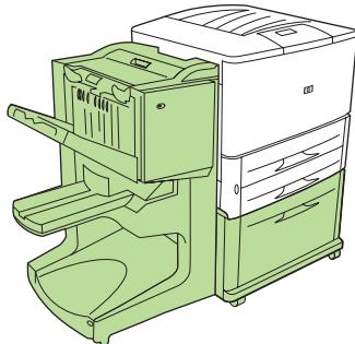
您必须先安装可选纸盘 4（2000 页进纸盘）或支架，才能将多功能装订器连接至打印机。
