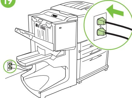
Συνδέστε ξανά το καλώδιο τροφοδοσίας του εκτυπωτή στην πρίζα. Συνδέστε και πάλι το καλώδιο τροφοδοσίας του δίσκου 4 ή της βάσης στην πρίζα.
