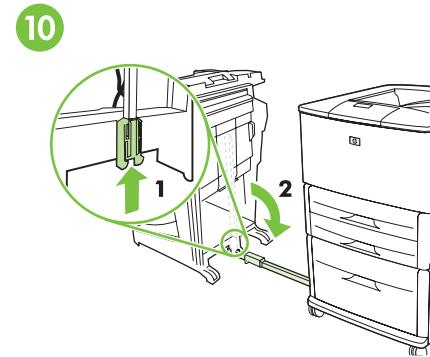
向上滑动蓝色托架以打开杆锁。将连接杆放低至水平位置。
