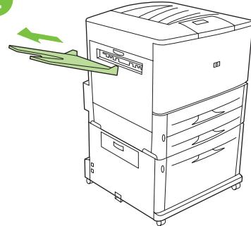
Αφαιρέστε το δίσκο με όψη προς τα πάνω (εάν τον είχατε τοποθετήσει) και φυλάξτε τον. Δεν χρησιμοποιείται όταν το πολυλειτουργικό μηχάνημα τελικής επεξεργασίας είναι συνδεδεμένο στον εκτυπωτή.
