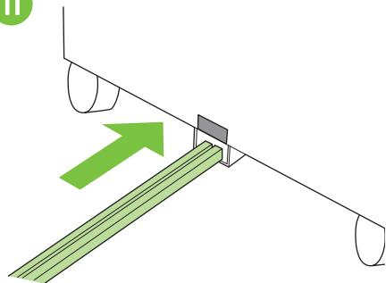
Sätt in änden på anslutningsstången i den U-formade metallskåran på fack 4 och rikta in stången mot den grå justeringsetiketten.
