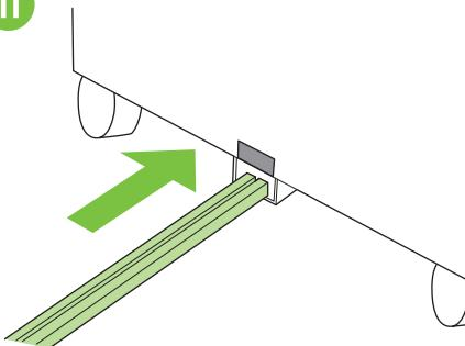
将连接杆的一端插入纸盘 4 或支架的 U 形金属槽中，并将连接杆与灰色校准标签对齐。
