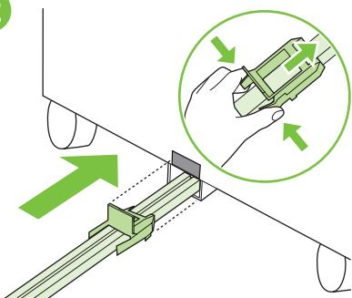
Skjut in den blå plastspärren i metallskåran tills den snäpper på plats.
