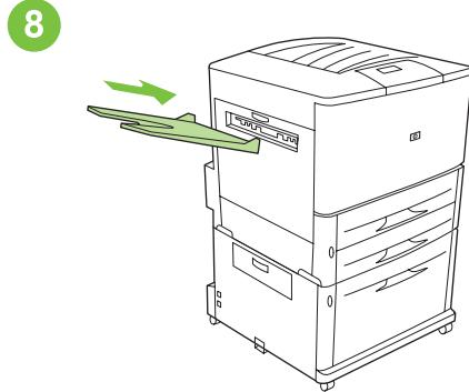
Anslut utmatningsfacket för framsidan uppåt som följer med skrivaren.
