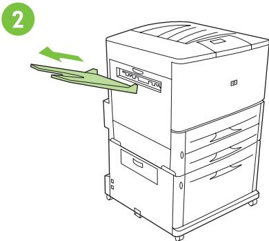
Wyjmij pojemnik wydrukiem w góre (jeśli go zainstalowano) i odłóż w bezpieczne miejsce. Po zainstalowaniu finisera wielofunkcyjnego pojemnik ten nie będzie używany.
