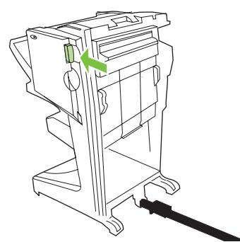
Naciśnij dźwignię zwalniającą i odsuń urządzenie od drukarki.
