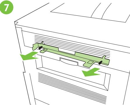
Odkręć śruby łączące listwę montażową z drukarką.
