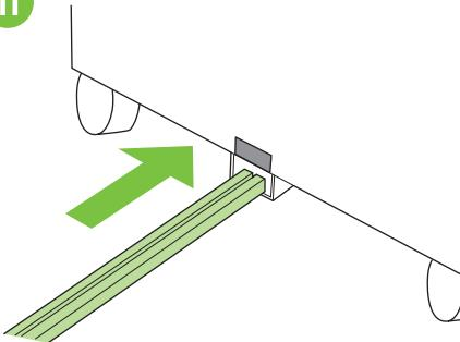
Τοποθετήστε το άκρο της ράβδου σύνδεσης στη μεταλλική υποδοχή σχήματος U στο δίσκο 4 ή στη βάση και ευθυγραμμίστε τη ράβδο με την γκρι ετικέτα ευθυγράμμισης.
