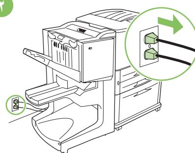
أفصل سلك التيار الخاص بالطابعة من مأخذ التيار المتردد. أفصل سلك التيار الخاص بالدرج ؛ أو الخاص بالحامل من مأخذ التيار المتردد.
