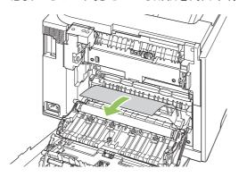
**4.** 詰まっている用紙が見えない場合は、両面印刷ユニットの側面にあるつまみを使用して、両面印刷ユニットを持ち上げます。
