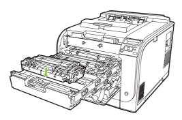
7. プリント カートリッジの左側に付いているタブを真上に引っ張り、密封テープを完全にはがし ます。密封テープを廃棄します。
