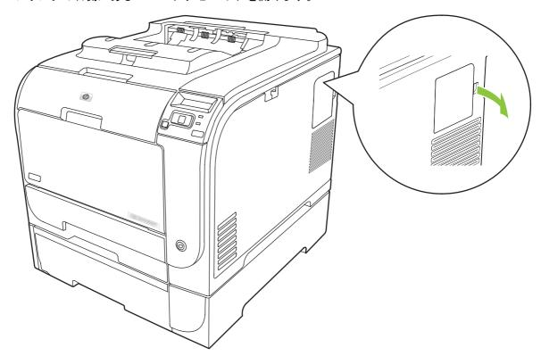
3. DIMM アクセス ドアを取り外します。
