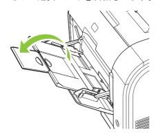
4. 用紙ガイドをフルに延長し (引出線 1)、メディア スタックをトレイ 1 (引出線 2) にセットしま す。用紙ガイドを用紙サイズに合わせて調整します。
