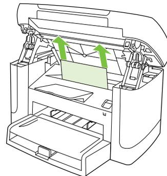
Extraiga de manera recta el soporte de impresión atascado del producto para solucionar el atasco. Si extrae el soporte de impresión atascado del producto en ángulo, podría dañar el producto.
