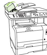
2 Cuando levante la palanca verde, gire el mecanismo de recogida hasta que quede abierto.
