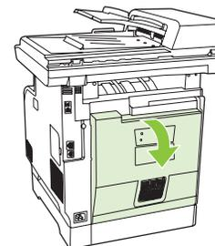
2 Si nécessaire, tirez sur le guide (légende 1) et retirez le papier visible (légende 2) par le bas de la zone de sortie.
