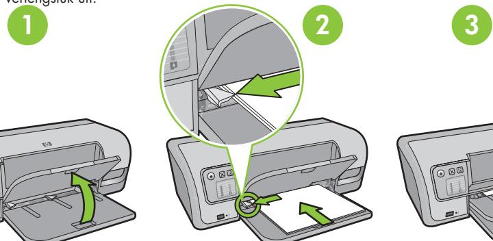
**3** Schließen Sie die obere Abdeckung. Schließen Sie die Stromversorgung an.
