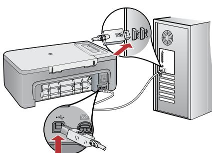
**DE** **Windows:** Sobald die USB-Aufforderung angezeigt wird, schließen Sie das USB-Kabel an den Anschluss auf der Rückseite des Geräts und anschließend an einen beliebigen USB-Anschluss des Computers an.
