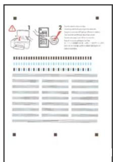
**DE** Schließen Sie die Druckpatronenklappe. Das Gerät druckt eine Ausrichtungsseite. Durch die Ausrichtung der Druckpatronen wird eine bessere Druckqualität sichergestellt.
