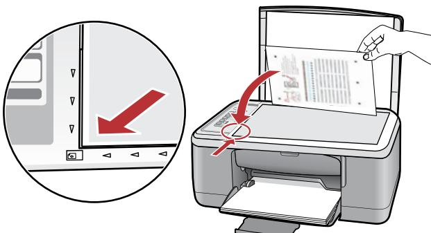
**DE** Legen Sie die Ausrichtungsseite nach dem Ausdruck mit der bedruckten Seite nach unten auf das Glas, wie in der Abbildung gezeigt. Schließen Sie die Abdeckung.
