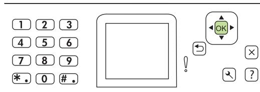
5 Wenn auf dem Bedienfeld die Meldung **Drucken mit [OK]** angezeigt wird, drücken Sie die Taste **OK**.
