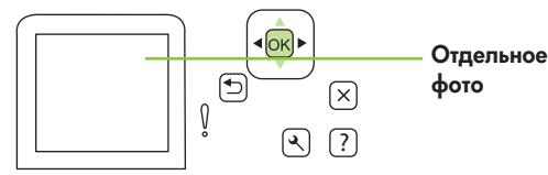
4 С помощью кнопок со стрелками или клавиш цифровой клавиатуры укажите значения для каждого из следующих элементов меню и нажмите **OK**.
