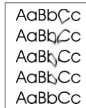
Manchas de tóner
