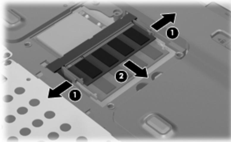
Para proteger o módulo de memória removido, guarde-o num recipiente à prova de electrostática.
