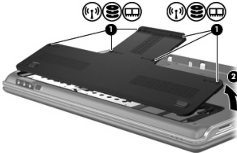
9. Se estiver a substituir um módulo de memória , remova o módulo de memória existente:
