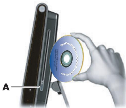
ディスクを取り出すには、電源が入っていることを確認してから、ディスク ドライブ側面の取り出しボタン (A) を押します。または、**Windows Vista**のスタート ボタン
