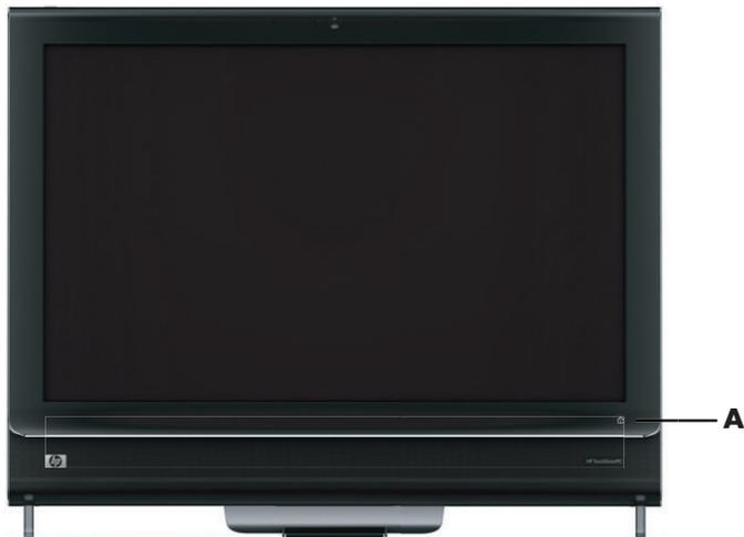
HP TouchSmartソフトウェアを起動するには、HP TouchSmart PCの右下にあるHP TouchSmartボタン (A) をタッチします。
