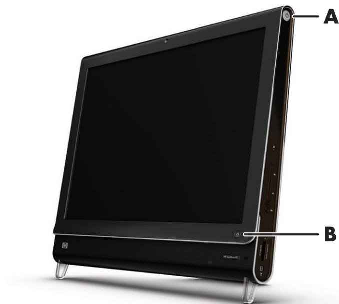
キーボードまたはリモコンの電源/スリープ ボタンを押して、HP TouchSmart PCの電源を入れたり、スリープモードにしたりすることもできます。リモコンは一部のモデルにのみ付属しています。
