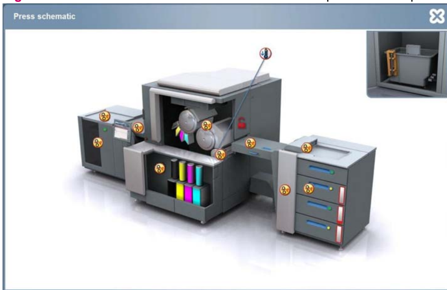
Figura 7-10 Indicadores de atasco de sustrato en el esquema de la imprenta (2 de 2)
