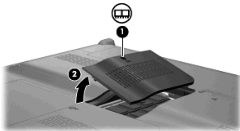
9. メモリ モジュールを交換する場合は、装着されているメモリ モジュールを取り外します。
