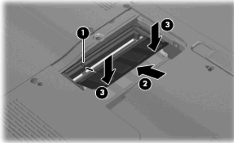
11. メモリ モジュール コンパートメント カバーのタブ (1) とコンピュータの切り込みを合わせます。
