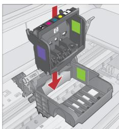
e. Baje el cabezal de impresión hasta insertarlo en el dispositivo.
