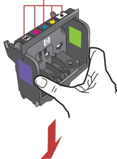
d. Mantenga el cabezal de impresión en posición vertical, como se muestra en la imagen.
