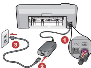
a. Conecte el cable de alimentación y el adaptador.
