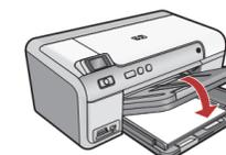
d. Baje la bandeja de salida y pulse **OK**.
