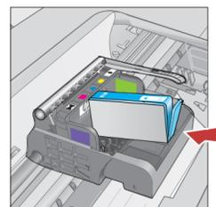
c. Dé la vuelta al cartucho de tinta, deslícelo en la ranura correcta y, a continuación, presione hasta que encaje en su sitio.
