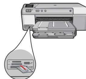
**b.** Inserte la tarjeta de memoria de la cámara en la ranura para tarjeta de memoria correspondiente del dispositivo HP.
