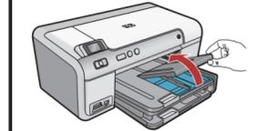
a. Heben Sie die Abdeckung des Fotofachs an.
