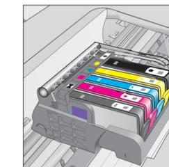
e. Schließen Sie die Zugangsklappe zu den Tintenpatronen. Die Initialisierung, die etwa 6 Minuten in Anspruch nimmt, wird gestartet. Dabei gibt das Gerät Geräusche von sich.
