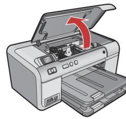
a. Öffnen Sie die Zugangsklappe zu den Tintenpatronen.
