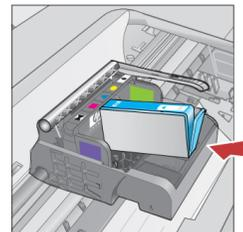
c. Drehen Sie die Tintenpatrone um, schieben Sie sie in den entsprechenden Steckplatz, und drücken Sie sie nach unten, bis sie einrastet.
