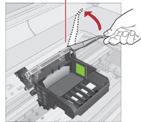
b. Schieben Sie die graue Verriegelung nach oben, wie im Bild dargestellt.
