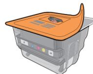
c. Nehmen Sie den Druckkopf aus der Verpackung. **Berühren Sie nicht** die kupferfarbenen Kontakte. **Verkratzen Sie die Kontakte nicht** am Drucker oder an einer anderen Oberfläche.
