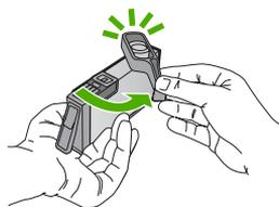
6. Guiando-se pelos ícones e pelas cores, deslize o cartucho de tinta no compartimento vazio até que ouça um clique e ele esteja bem colocado.
