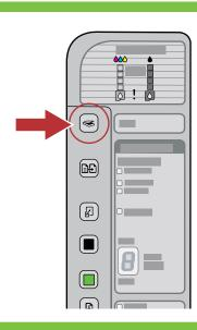
Presione (botón **Escanear**) para completar la alineación. El proceso de alineación dura diez segundos.
