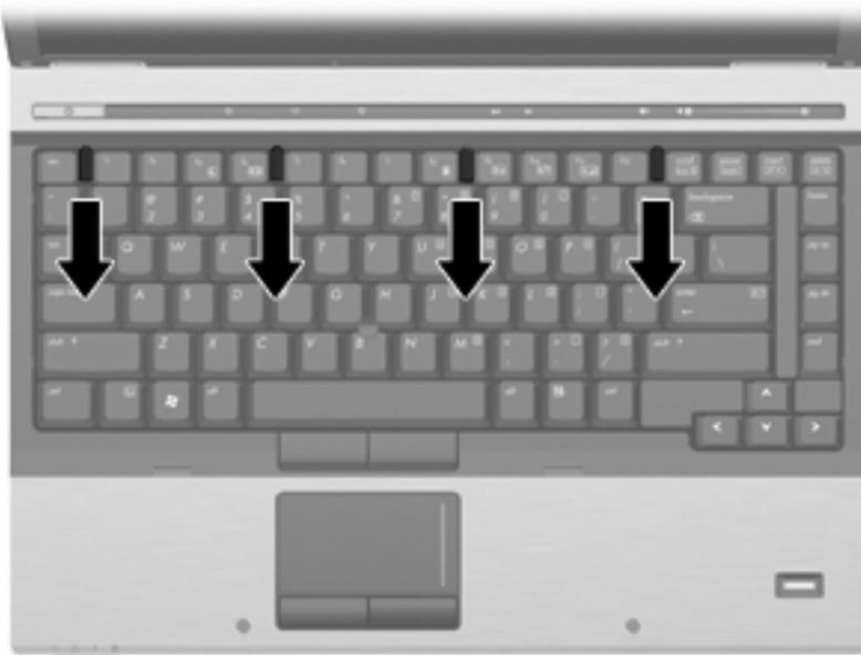
10. Soulevez délicatement le bord supérieur du clavier et faites pivoter le clavier jusqu'à ce qu'il soit sur le repose-poignet de l'ordinateur.
