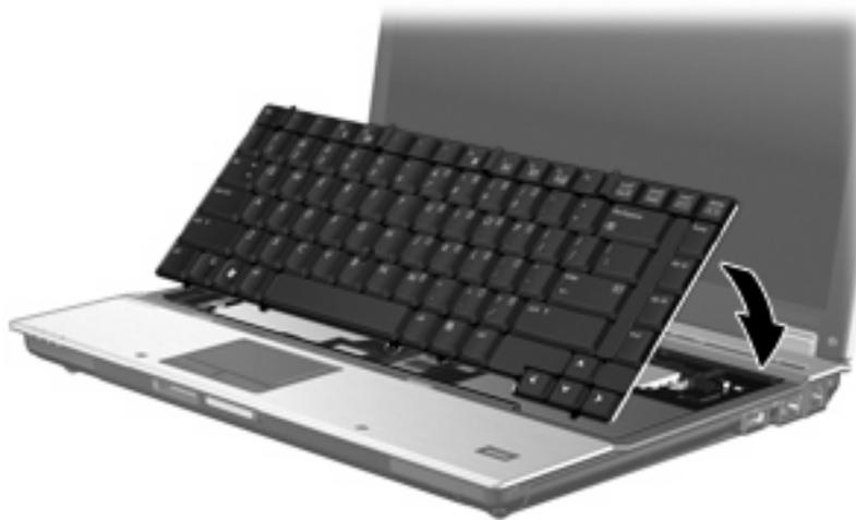
14. Faites glisser les 4 loquets de retenue du clavier pour verrouiller ce dernier.
