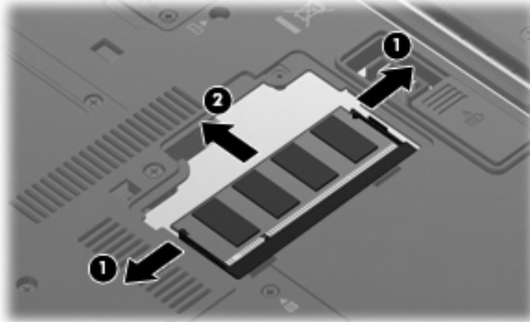
Pour protéger un module mémoire retiré, placez-le dans un emballage de protection contre l'électricité statique.
